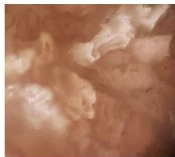
(d) Cross-sectional view of Ramie fibre
